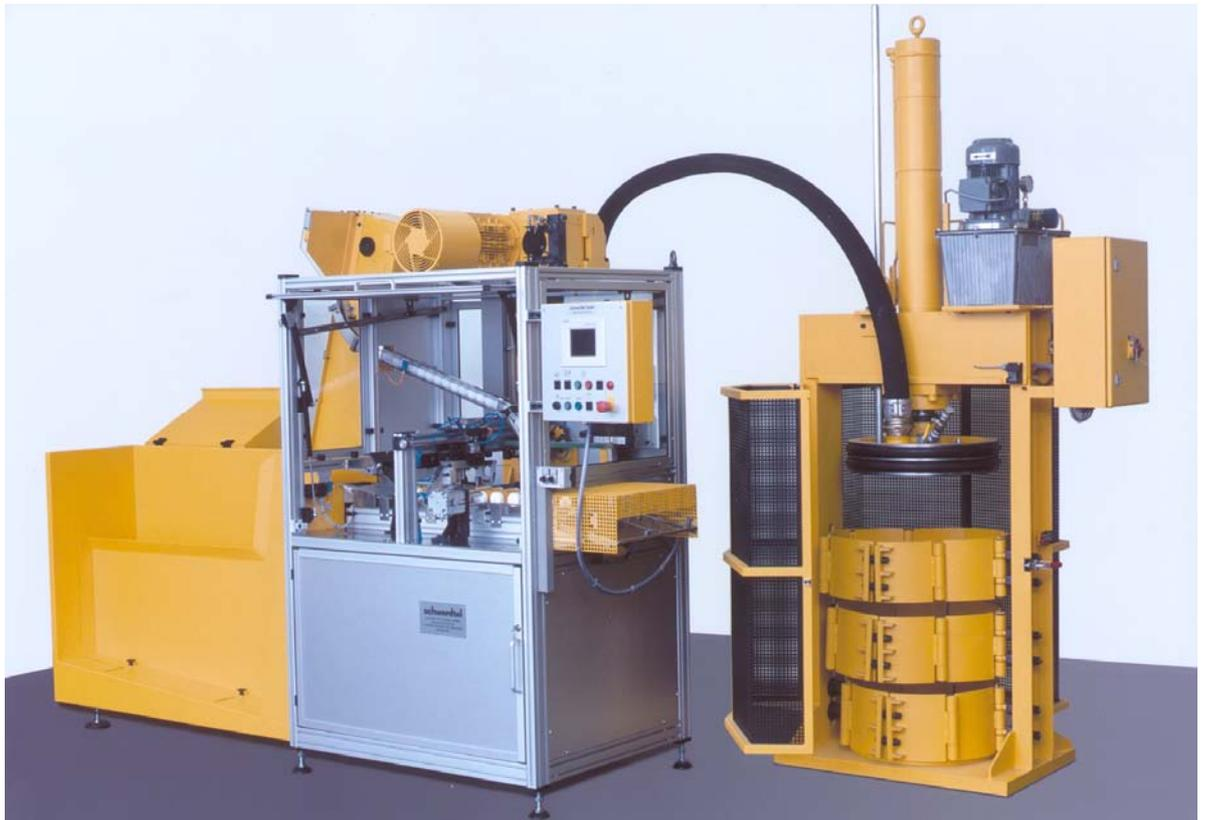
**Die Kompaktanlage mit einer Abfüll-Leistung von bis zu 53 Kartuschen / Minute**
