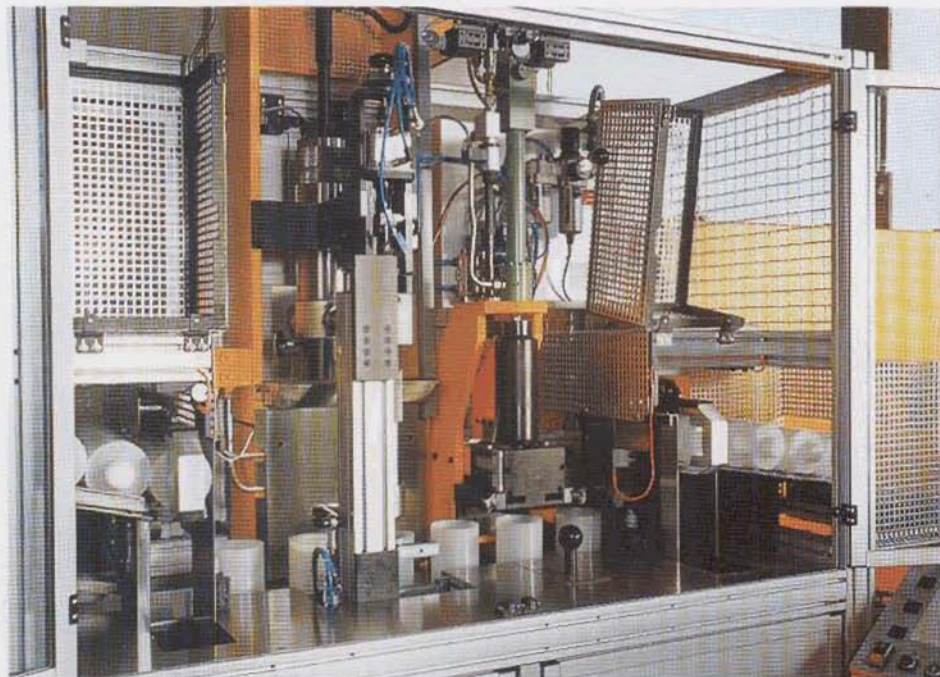
Abfüll- und Kolbensetzstation
